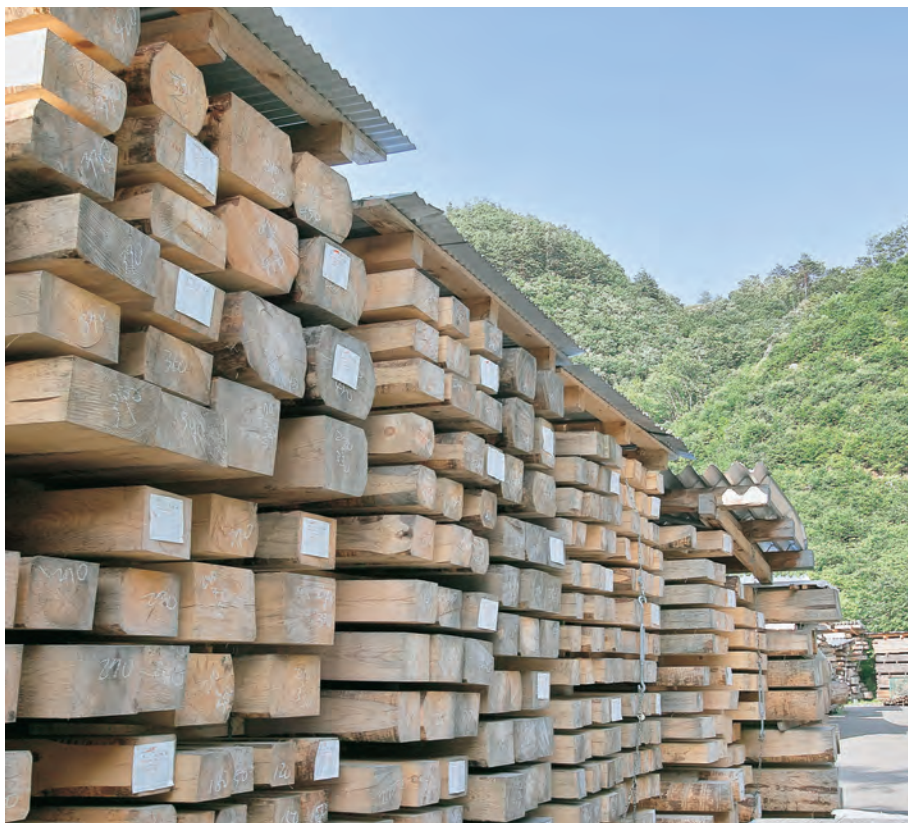
栈積みした上に屋根を掛けて天然乾燥
